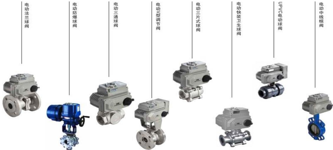
工业水路电动阀作为工业控制较为广泛，主要分为电动蝶阀、电动球阀，按控制功能要求分为开关型和调节型，其全电子式电动执行机构，采用机电一体化结构，具有机内伺服操作和开度信号位置反馈、位置指示、手动操作等功能，功能强、性能可靠、连线简单、控制精确、体积小、重量轻、流阻小、流量系数大，结构简单、密封性能好。调节范围大，通过输入电流信号或电压信号，将此转变成与输入信号相对应的位移，改变阀板或球体的旋转角度，因此一定的输入信号对应一定的转角，实现比例动作，故有较好的调节控制流量等参数。
